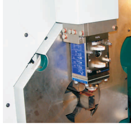
Precitec bietet Bearbeitungsköpfe mit hochwertiger Optik. Zusatzkomponenten wie Vertikaljustage, Strahlumlenker und Kamerabeobachtung mit integrierter Beleuchtung ergänzen das Paket.
