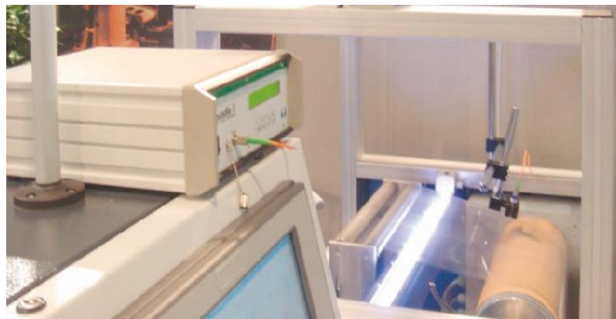
Die Messung der Foliendicke lässt sich platzsparend in den laufenden Prozess einbauen.
