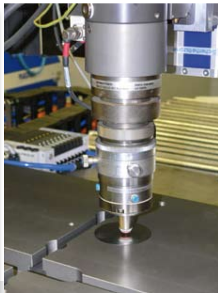
Bild 1 und 2: Precitec Feinschneidköpfe im Einsatz bei BBW Lasertechnik
