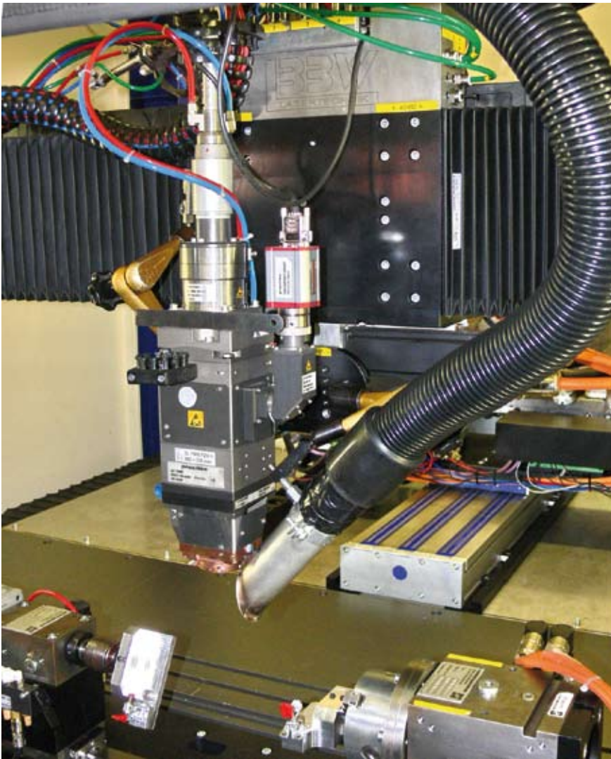
Bild 6: Faserlaserstation mit Precitec Schweißkopf und Kamerasystem
