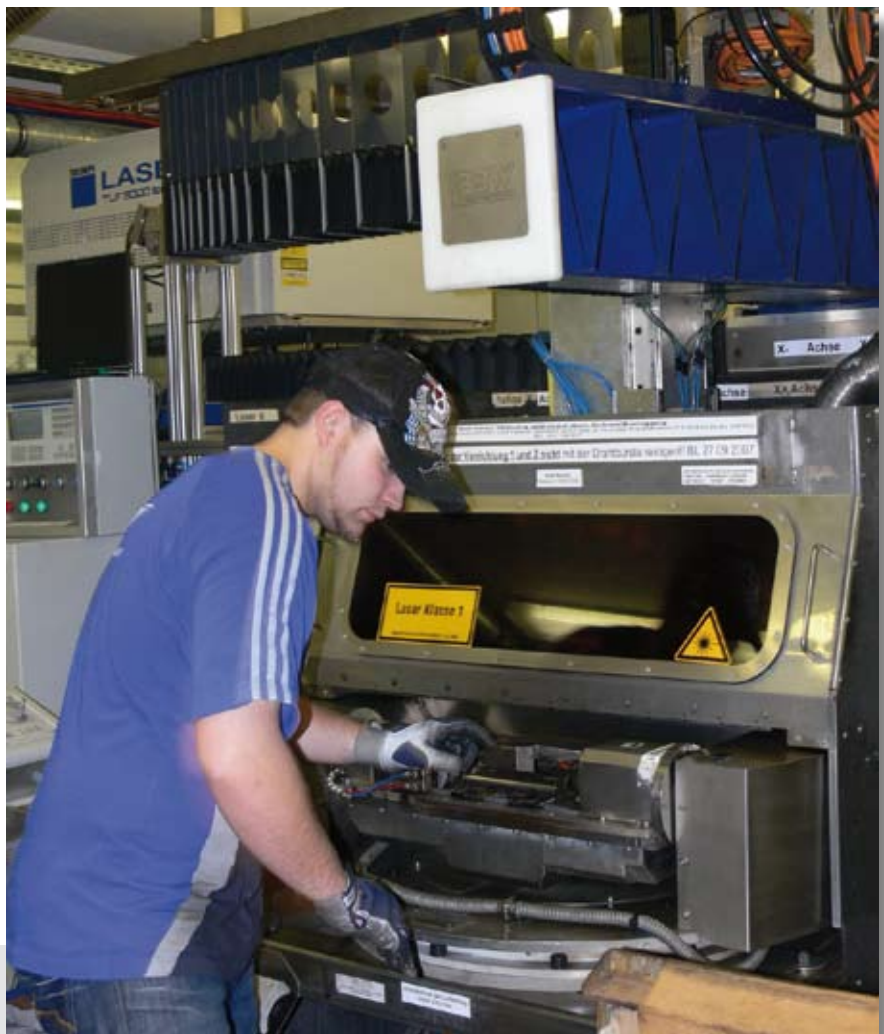
Bild 5: Schweißstation für Automobilserienteile
