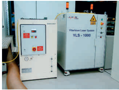
Die 1-kW-Faserlaserstrahlquelle (rechts) und das Laserkühlgerät.
