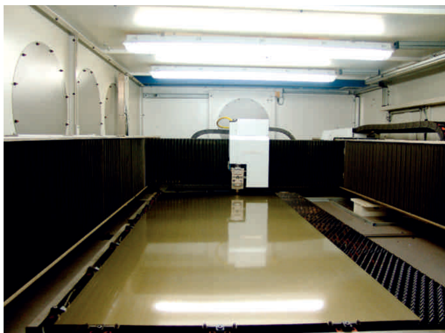
Hochdynamisches Schneiden von Dynamoblechen mit Beschleunigungen bis 4g. Die maximale Beschleunigung beträgt 7g. Alle Fotos: Klinker
