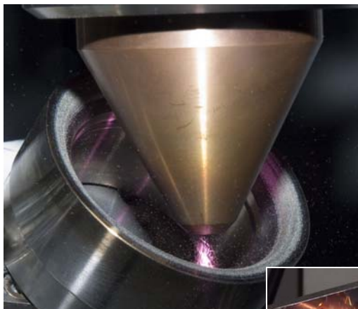
radiales Beschichten von Ventilsitzen
